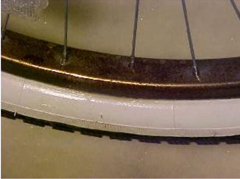
鋼鐵鍍鉻生銹（自行車輪圈為例）
